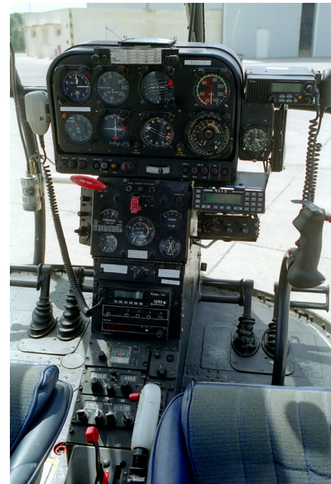
Le tableau de bord des Alouette «SAR» comporte des équipements spécialisés comme des radios «marine» et un GPS (Pierre Gillard).
