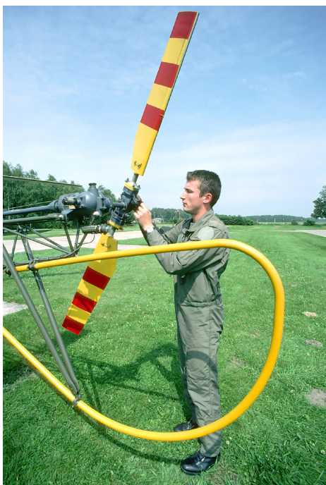
Inspection du rotor anti-couple (Pierre Gillard).
