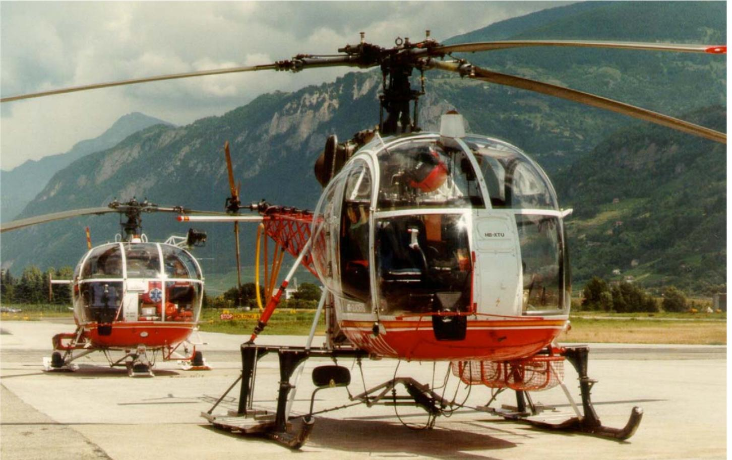
*Les deux principaux types d'hélicoptères exploités par Air Glaciers : le Lama pour le levage et l'Alouette III essentiellement pour le sauvetage en montagne ( photo © Pierre GILLARD )*
