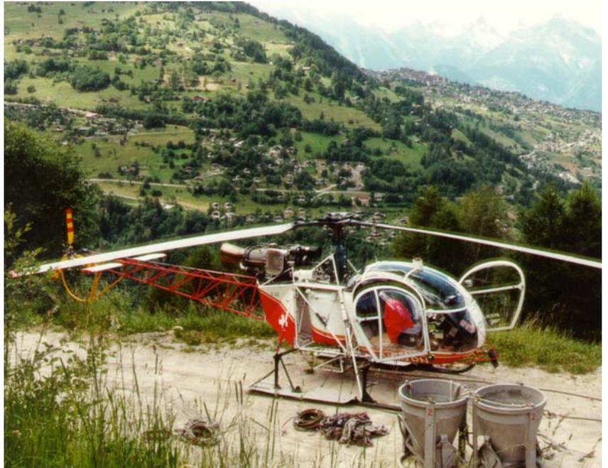
*Préparation du Lama « Romeo-November » pour une opération de bétonnage sur un chemin de montagne
