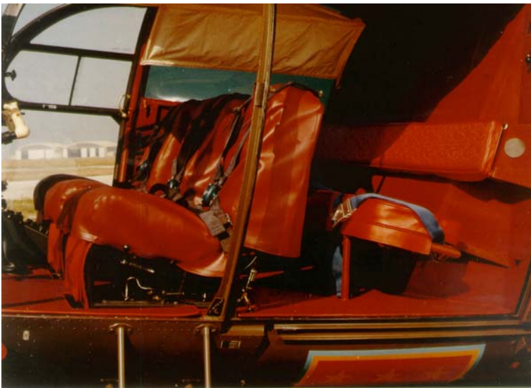
Détail de l'intérieur de l'Alouette 1359. Les sièges sont recouverts de housses en cuir rouge et les vitres latérales sont teintées ( Document Aérospatiale ).
